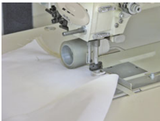
Aufnähen von PVC oder Silikonflachkeder von unten
